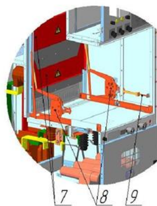
Рисунок – 4. Отсек ВЭ шкафа КСО с силовым выключателем
